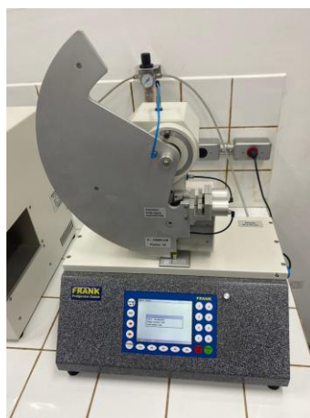
Figura 12 – Equipamento utilizado para teste de Resistência ao rasgo.
