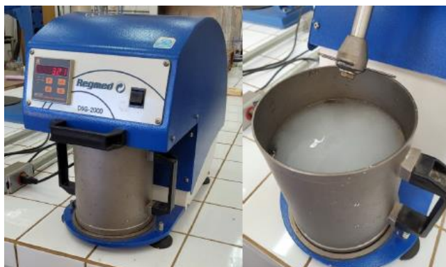
Figura 5 – Desagregador de laboratório e polpa desagregada.
