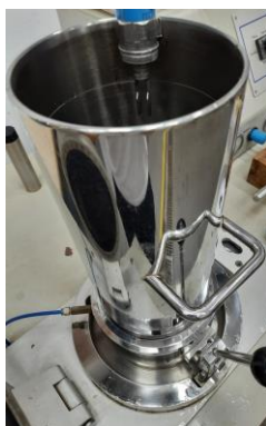
Figura 7 – Máquina formadora de papel.
