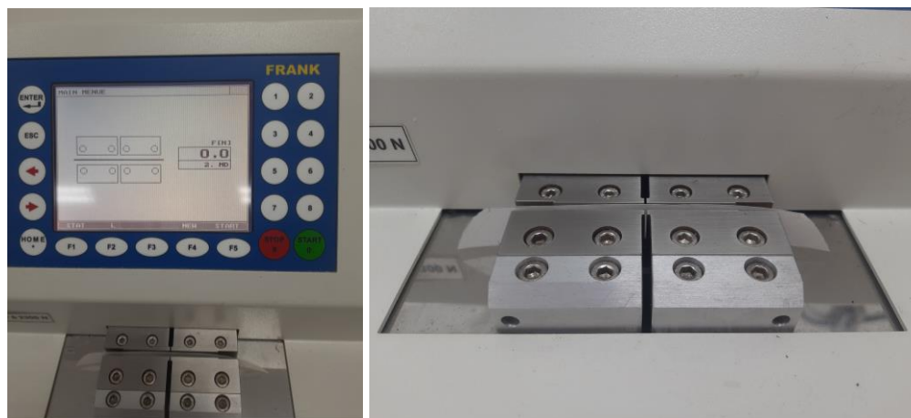
Figura 10 – Equipamento utilizado para teste de Resistência à Compressão.
