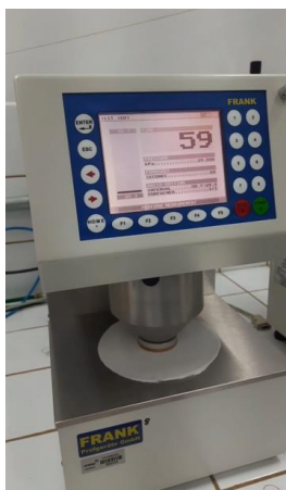
Figura 13 – Equipamento utilizado para teste de Lisura.
