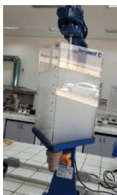
Figura 6 – Mistura no homogeneizador.
