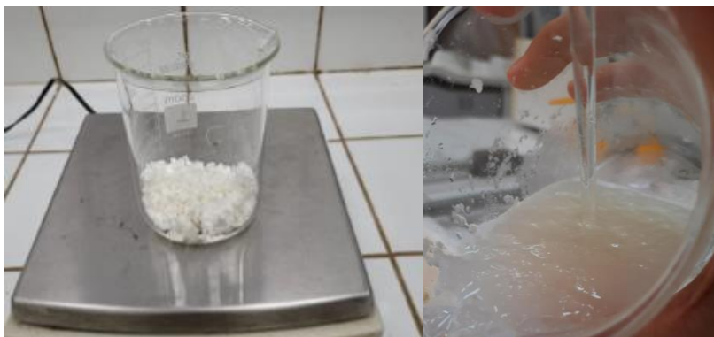
Figura 4 – Pesagem da amostra de celulose e solução de nanocelulose 3%.
