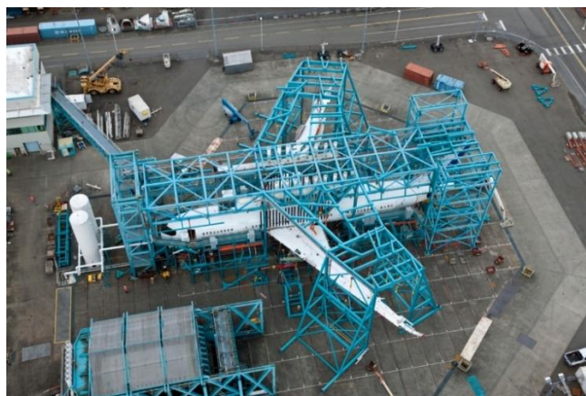
Figura 6 – Estrutura do ensaio estático e fadiga do Boeing 787
