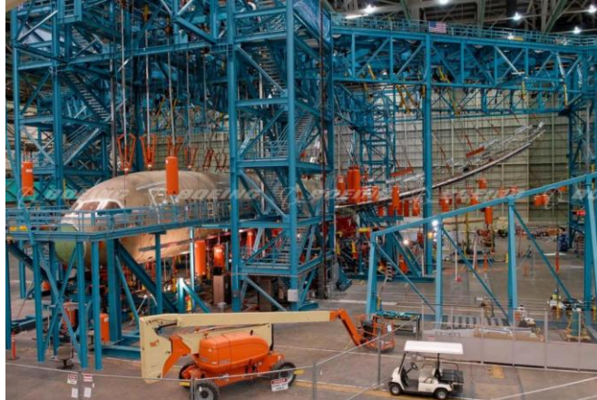
Figura 5 – Ensaio estático de flexão da asa do Boeing 787
