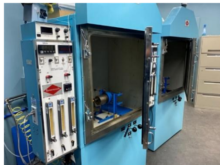
Figura 8 – Máquina para ensaios de toxidade e densidade de fumaça
