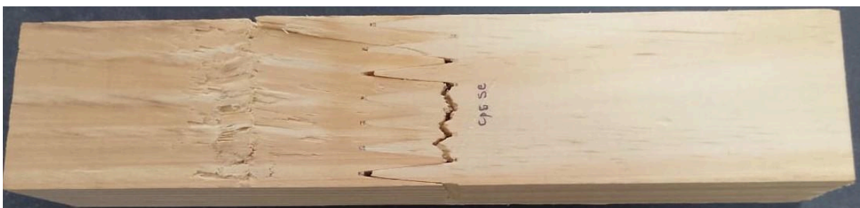
Figura 8 - Ruptura na emenda do corpo de prova.
