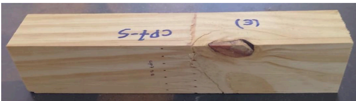
Figura 9 - Presença de defeitos nos corpos de prova.
