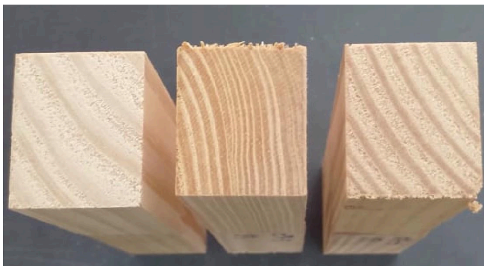
Figura 11 - Variação visual dos anéis de crescimento nos corpos de prova
