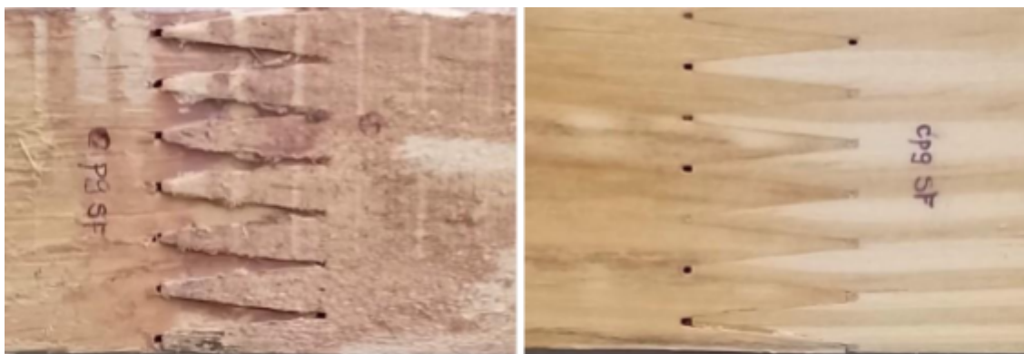
Figura 2 – Exemplo de corpo de prova antes (esquerda) e após (direita) o preparo para a análise geométrica da emenda finger joint.
