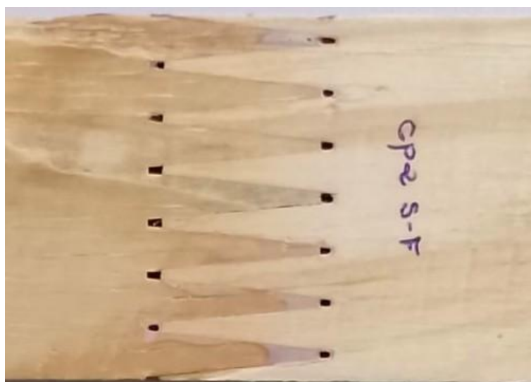
Figura 1 – Detalhe da geometria dos dentes da emenda finger joint.
