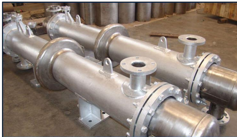
Figura 1 - Trocadores de calor fabricados com Aço Superduplex UNS S 32750.
