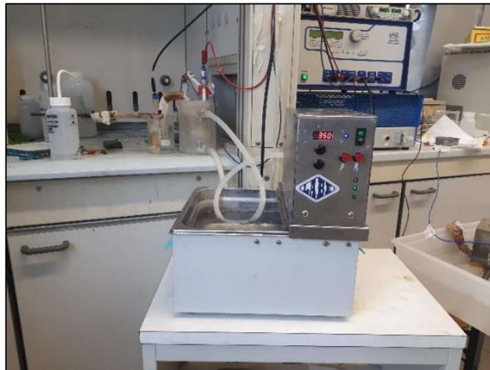
Figura 37 - Aparato para ensaio de corrosão (CPT).
