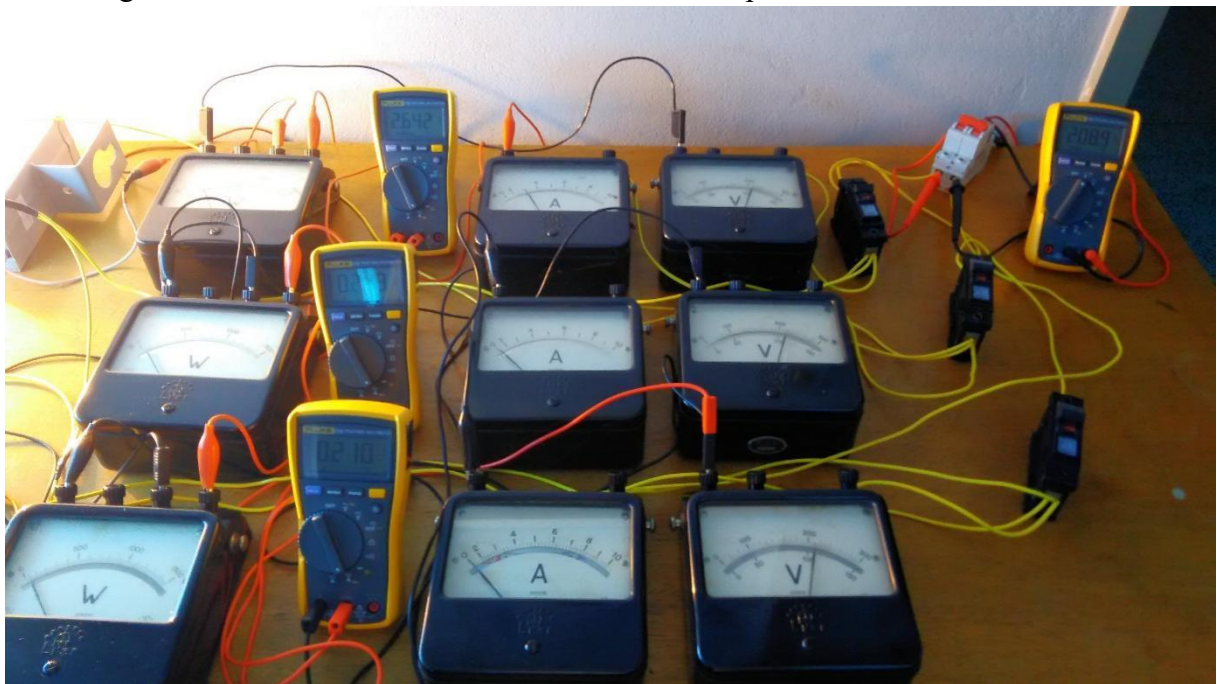
Figura 16 – Testes realizados com Voltímetros, Amperímetros e Wattímetros.
