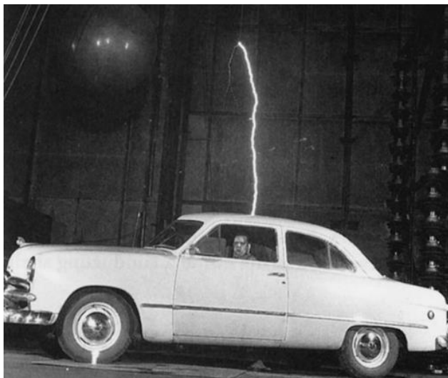
Figura 13: Uma descarga elétrica atinge o automóvel, percorre a superfície e chega à terra através de uma centelha que parte da roda.
