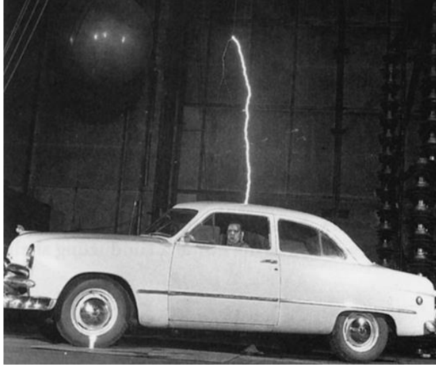
Figura 12: Uma descarga elétrica atinge o automóvel, percorre a superfície e chega à terra através de uma centelha que parte da roda.
