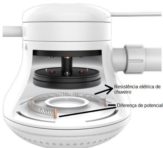
Figura 16: Chuveiro elétrico; visão em corte.
