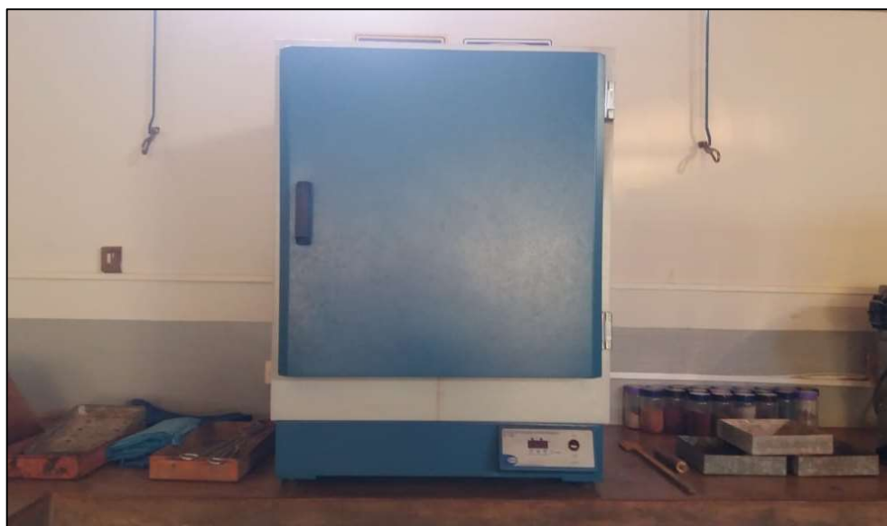
Figura 15 - Estufa utilizada no processo de secagem da casca de banana.
