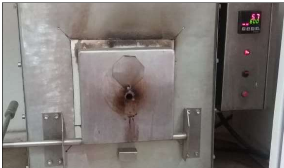
Figura 16 - Mufla utilizada no processo de calcinação dos resíduos agroindustriais.
