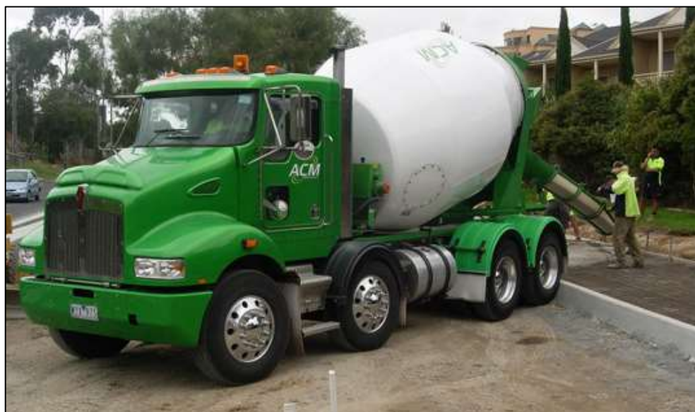
Figura 11 - Concreto ativado alcalinamente sendo transportado em larga escala.
