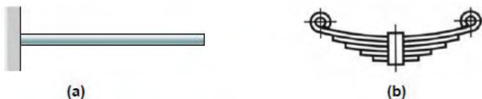
Figura 5 – Molas planas: (a) lâmina e (b) lâminas múltiplas [MENDES, 2003].
