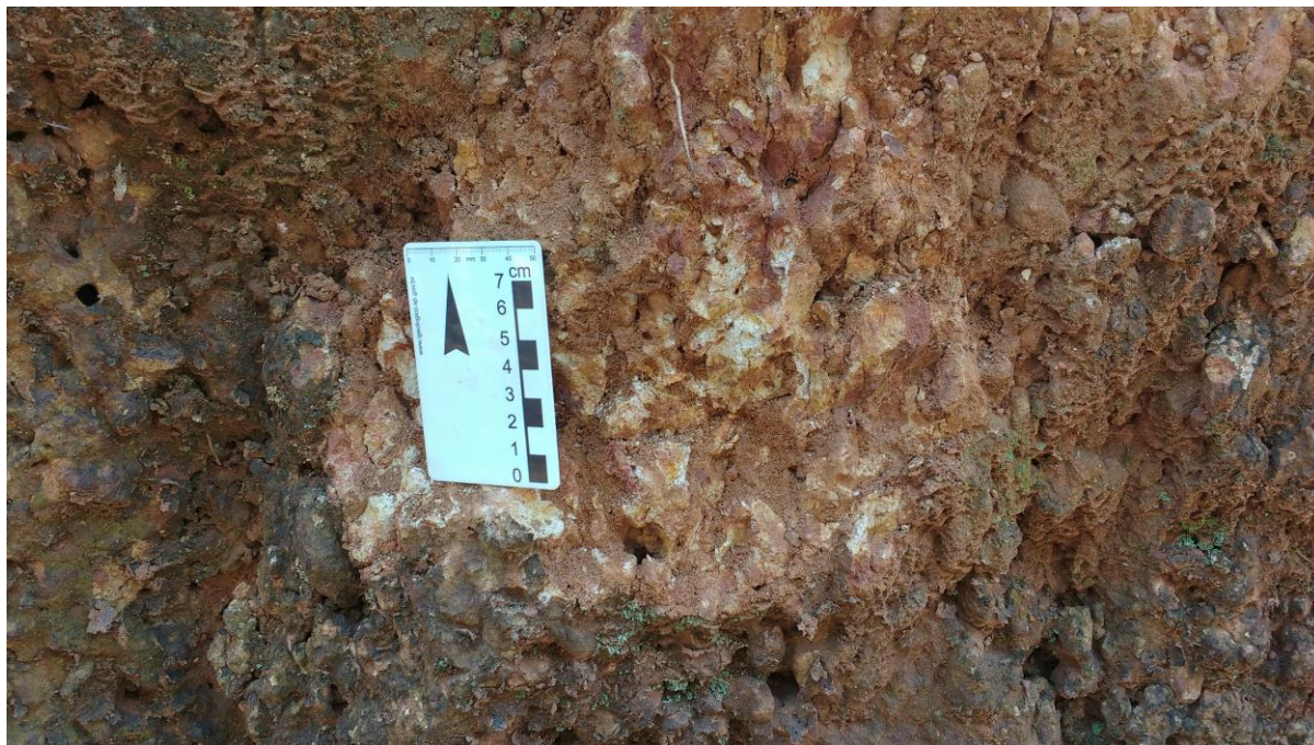
Figura 13 – Processo de laterização na Formação Itaqueri
