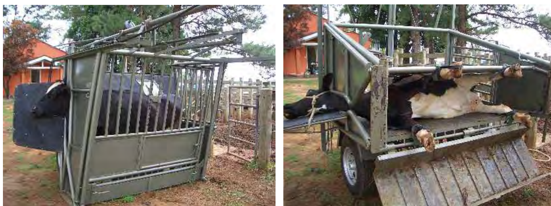
FIGURAS 2a e 2b - Tronco tombador hidráulico utilizado no experimento.
