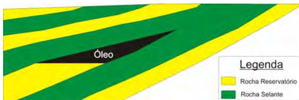
Figura 11: Modelo de um trapeamento estratigráfico pelo adelgaçamento da borda do reservatório ( Pinchout ).
