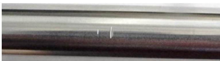
Figura 7: Defeito “haste picada” nas peças finais.
