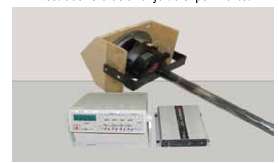
Figura 22 - Sistema de perturbação composto por caixa em forma de “V” e alto-falante para baixas frequências, mostrado fora do arranjo do experimento.
