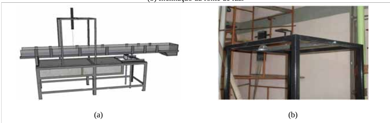
Figura 29 – Suporte para a fonte de luz com transferidor. (a) Mesa e canal - detalhe do suporte móvel da fonte de luz. (b) Inclinação da fonte de luz.
