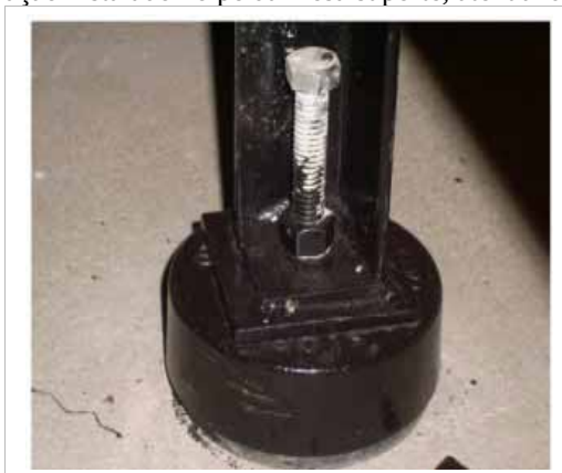
Figura 15 - Dispositivo anti-vibração instalado no pé da mesa suporte, atenuando vibrações externas ao conjunto.
