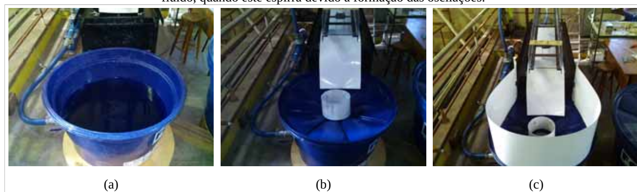
Figura 19 – Reservatório de carbopol. (a) Reservatório aberto. (b) Reservatório fechado - detalhe mostrando dispositivo para amortecer o impacto e canalização para guiar o fluido até o meio do reservatório. (c) Proteção para não perder o fluido, quando este espirra devido à formação das oscilações.
