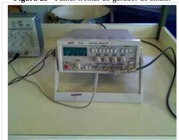
Figura 23 - Painel frontal do gerador de sinais.
