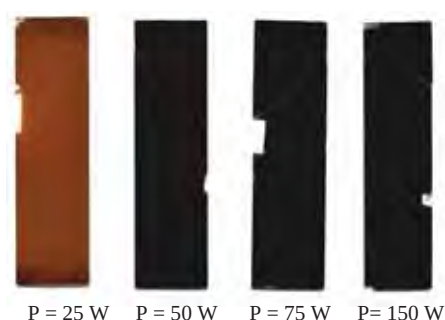
Fig.4.1.11 – Imagem fotográfica de filmes depositados sobre lâminas de microscópio.
