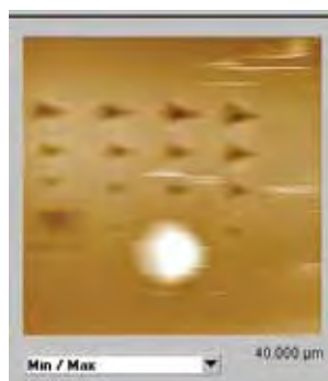
Fig.4.2.9 – Imagem de microscopia de força atômica de varredura de uma matriz de indentações produzida no filme como-depositado.
