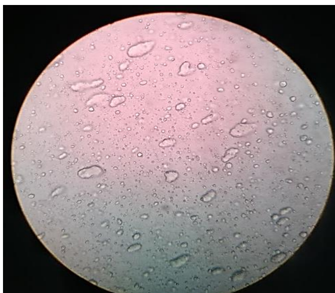
Figura 15. Microscopia da emulsão com extrato de pitaya, submetida à temperatura de 45° C, no 15° dia de ensaio.
