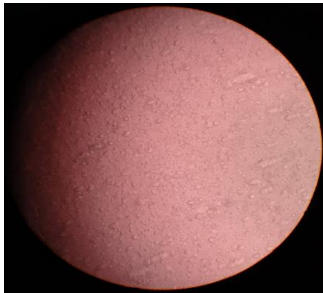
Figura 23. Microscopia da emulsão com extrato de pitaya, submetida à temperatura de 25° C, no 90° dia de ensaio.
