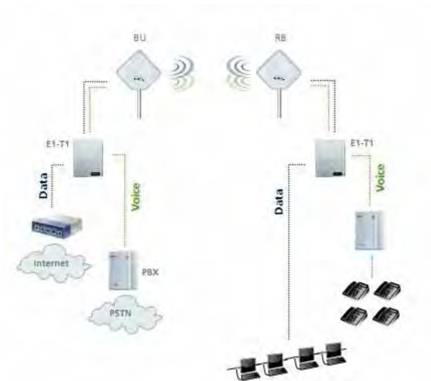
Figura 32 - Aplicação BU/RB BreezeNET B (Alvarion, 2011)
