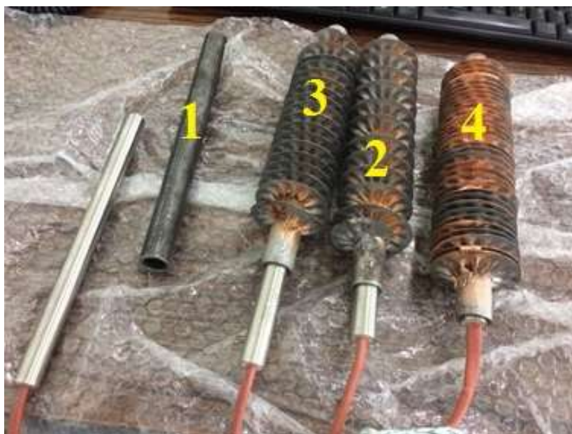
Figura 19. Tubos aletados e tubo liso com as resistências elétricas
