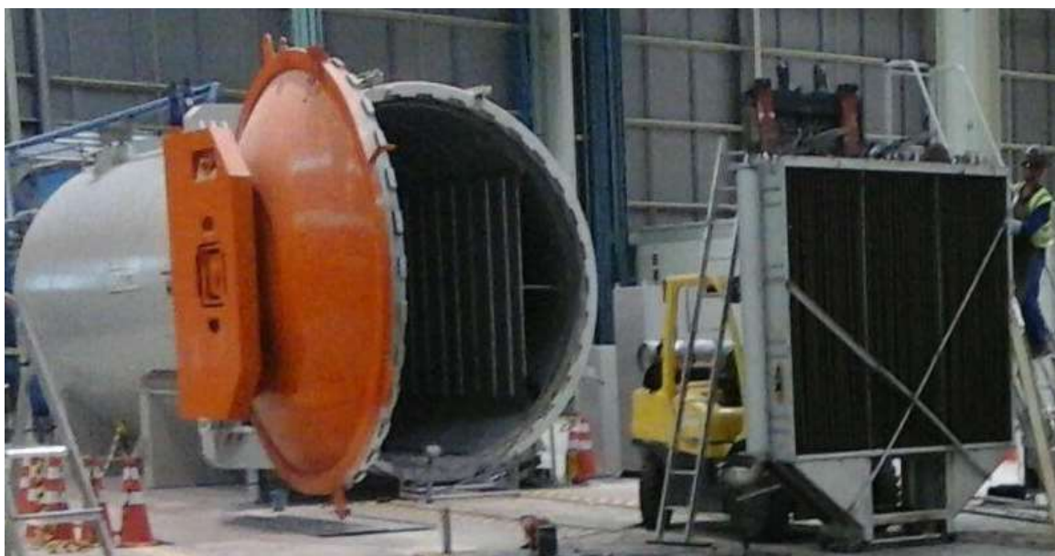
Figura 6. Trocador de calor de uma autoclave (retirado para manutenção).
