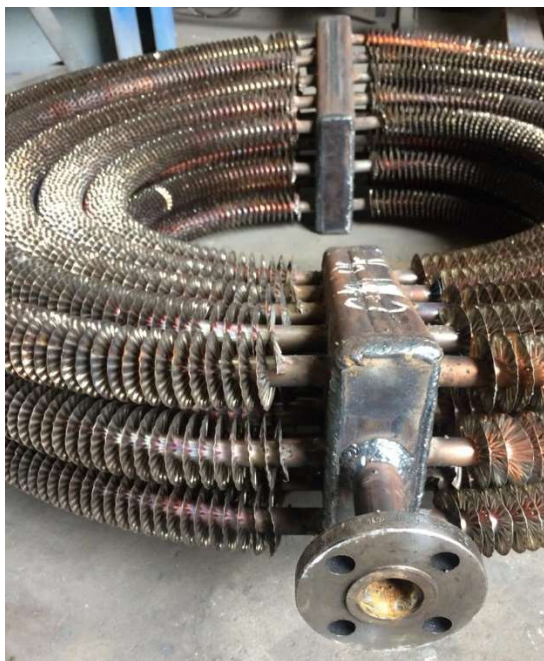
Figura 15. Trocador de calor com tubos circulares aletados
