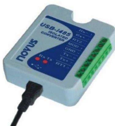
Figura 25. Conversor USB-i485 com comunicação RS-485
