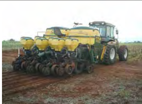
Conjunto trator-semeadora-adubadora para adubação em pré-semeadura
