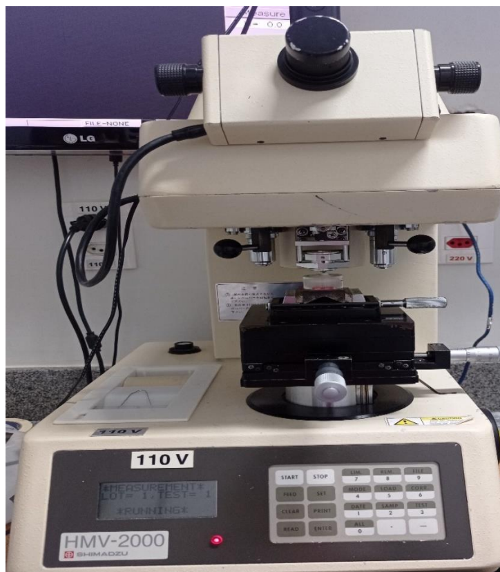
Figura 4 – Microdurômetro (SHIMADZU, Maryland, USA) utilizado para realizar as análises da microdureza superficial do esmalte
