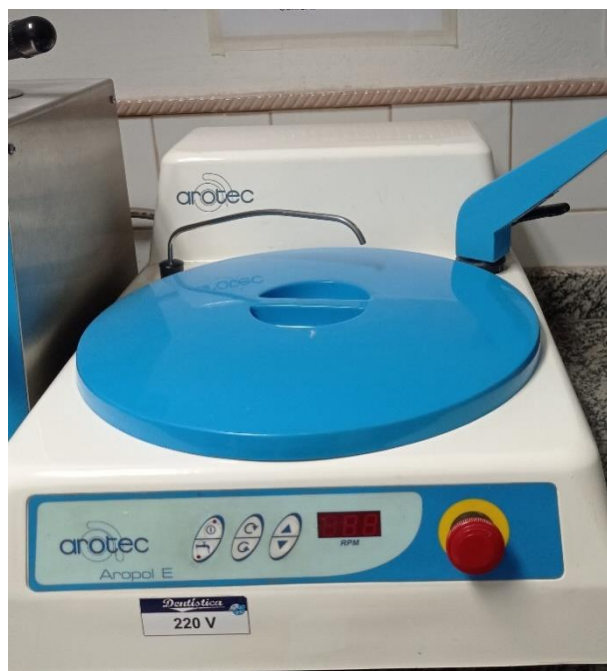
Figura 3- Politriz (Aropol E- Arotec Indústria e Comércio Ltda, Cotia, São Paulo, Brazil) utilizada para o aplainamento e polimento da superfície do esmalte
