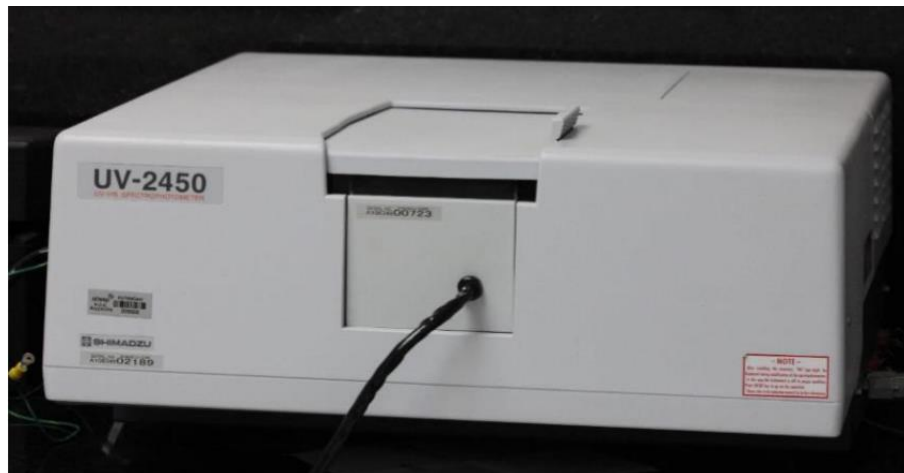
Figura 9- Espectrofotômetro (Ultraviolet Visible Model UV-2450; Shimadzu) utilizado para realizar as leituras de \Delta E
