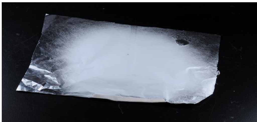
Figura 6- Scaffold polimérico distribuído sobre o coletor plano de alumínio
