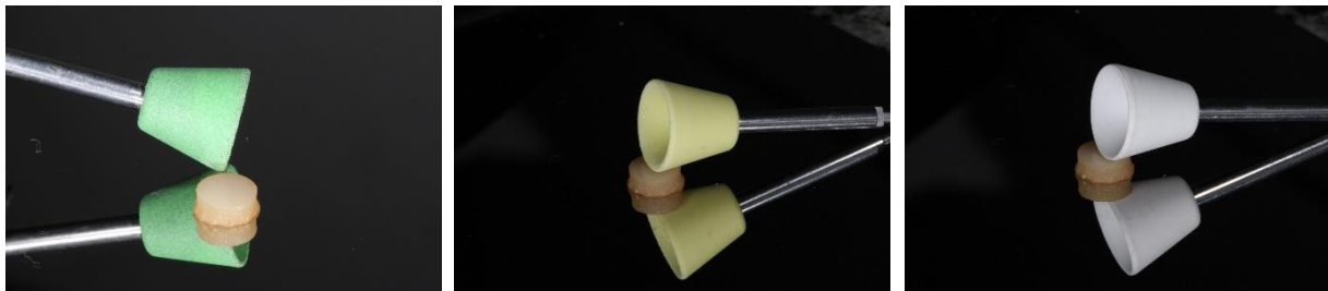
Figura 4 – Sistema de borrachas abrasivas de granulação grossa, média e fina (verde, amarela e branca respectivamente)
