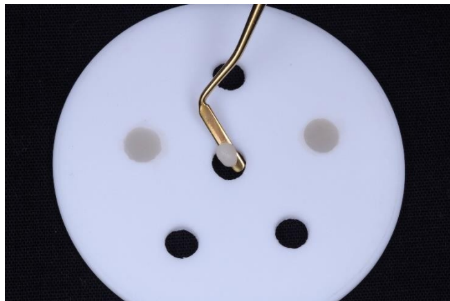
Figura 1 – Inserção de incremento de resina composta na matriz de politetrafluoretileno
