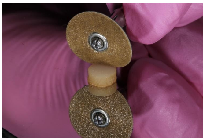
Figura 3 – Disco Sof-Lex sendo posicionado no espécime de resina composta
