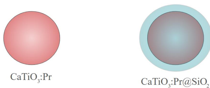
Figura 8 - Esquema simplificado do sistema casca núcleo (@). Imagem autoral.
