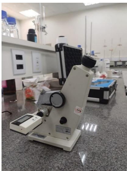
Figura 9 – Refratômetro utilizado para medir o índice de refração
