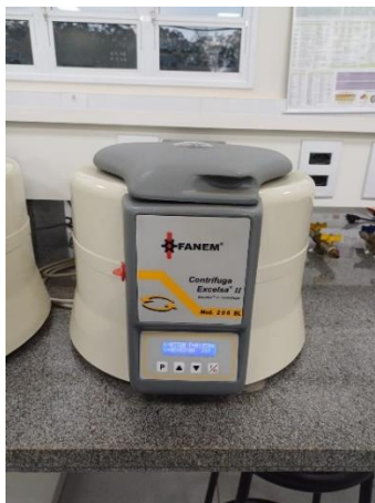
Figura 13 – Centrífuga utilizada para separação da glicerina e biodiesel.
