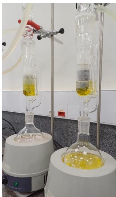
Figura 5 - Processo de Extração: método Soxhlet.
