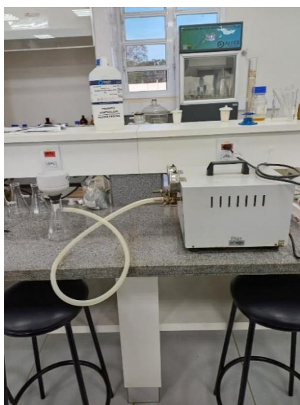
Figura 12 – Bomba a vácuo: sistema de filtragem.
