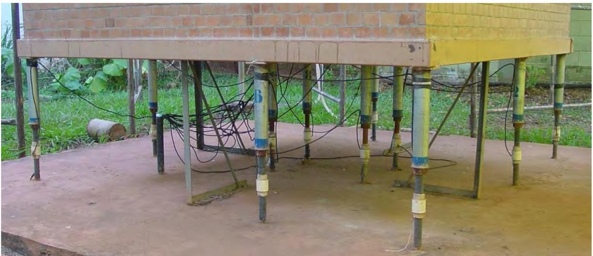
Figura 55 - Detalhe das células de carga sob o edifício.
