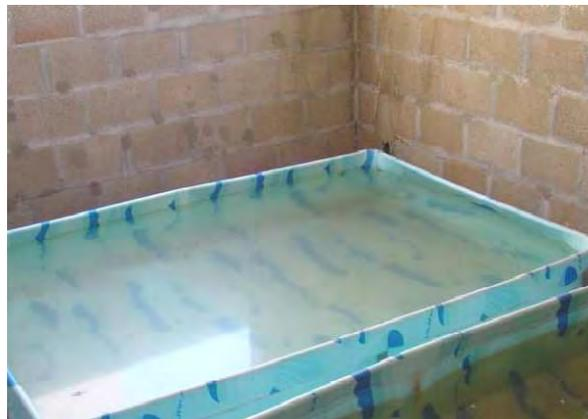
Figura 43 - Piscinas utilizadas para prova de carga, (ANDOLFATO, 2006, p. 142).
