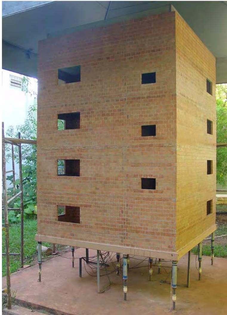
Figura 54 - Edifício em alvenaria estrutural cerâmica em escala reduzida.
