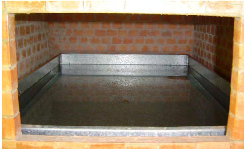
Figura 57 - Carga (água) uniformemente distribuída sobre a laje do ambiente 1.
