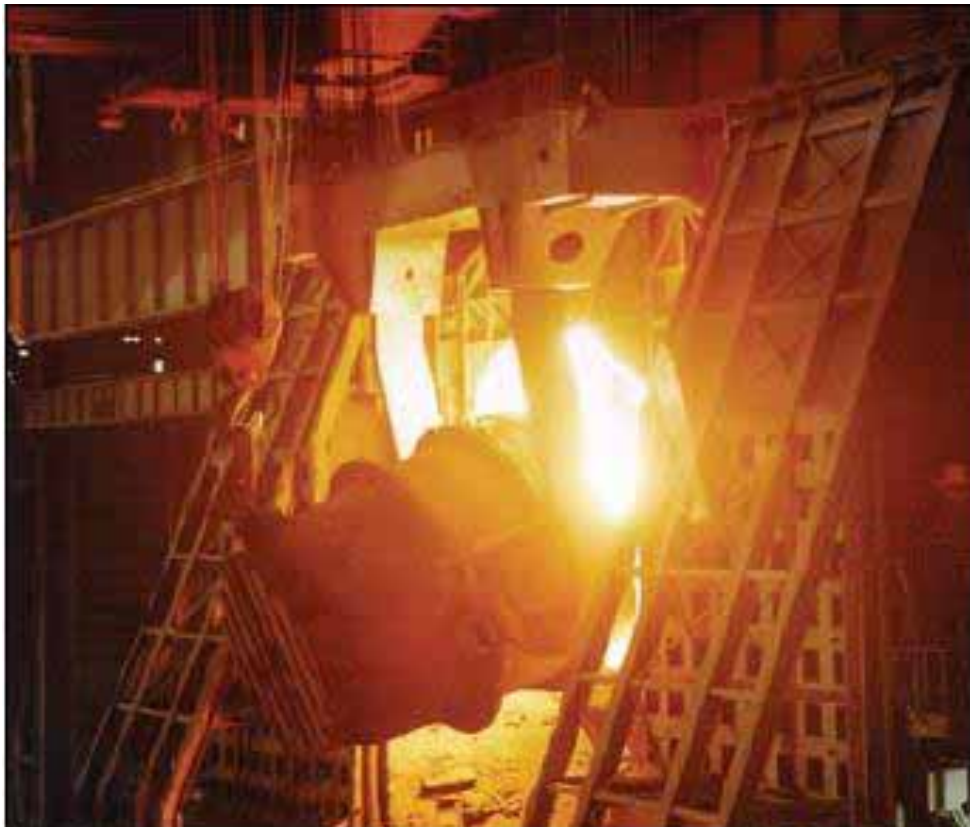
Figura 3.19 – Carregamento de gusa. (MOREIRA e LANA, 2002)
