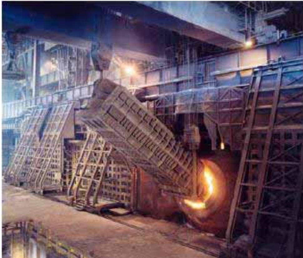
Figura 3.18 – Carregamento de sucata no conversor LD. (MOREIRA e LANA, 2002)
