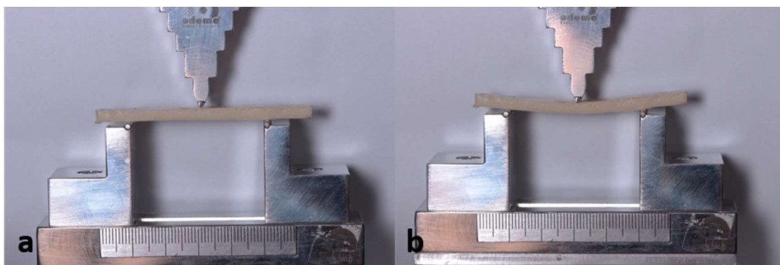
Figura 5. a. espécime submetido aos testes de RF e ME b. espécime durante a aplicação de carga para a realização dos testes de RF e ME.
