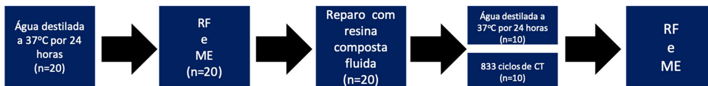
Figura 1. Fluxograma da divisão dos materiais com os tipos de reparo. RF = resistência flexural, ME = módulo de elasticidade e CT = ciclagem térmica.
