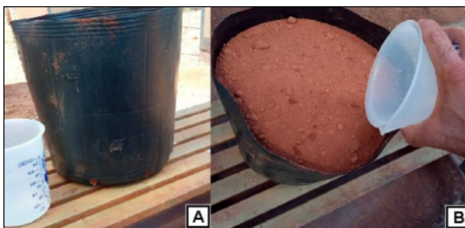
Figura 10 - Cálculos para as lâminas d'água: A) Seleção de uma UE para o teste da CV; B) Despejo de 1 L de água na UE com solo.
