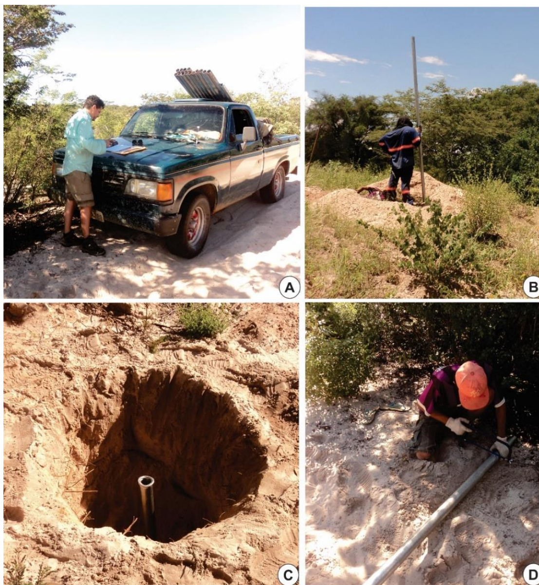
Figura 2.1: Sondagem rasa no campo eólico. A) Carro apropriado para região; B) Escavação de ~1m de profundidade antes de inserir o tubo amostrador; C) Tubo amostrador inserido a percussão; D) Separação de amostra para datação LOE.
