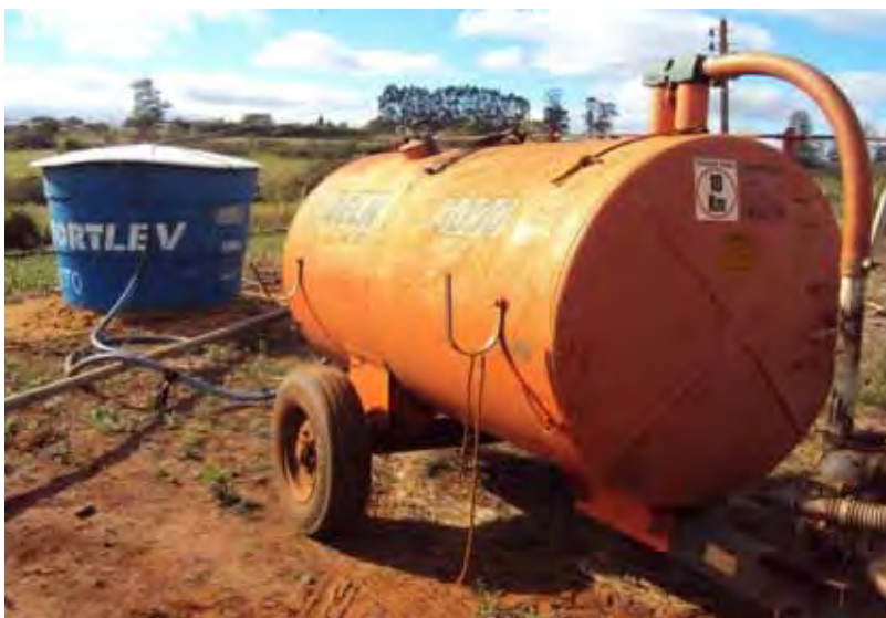
Figura 4 - Transporte do efluente de esgoto doméstico tratado realizado com carreta-pipa
