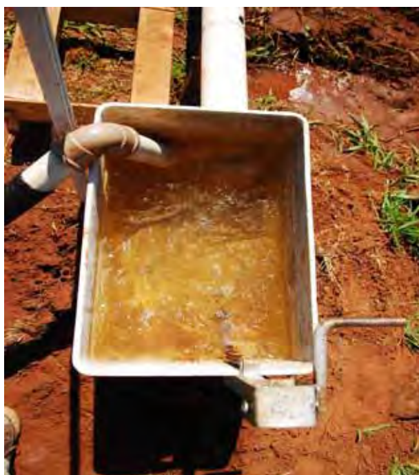
Figura 8- Detalhe da caixa de recepção e da roldana do sistema de irrigação Fonte: Scaloppi (2011)
