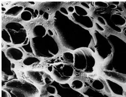
Figura 6 - Estrutura porosa do grão de carvão ativo.
