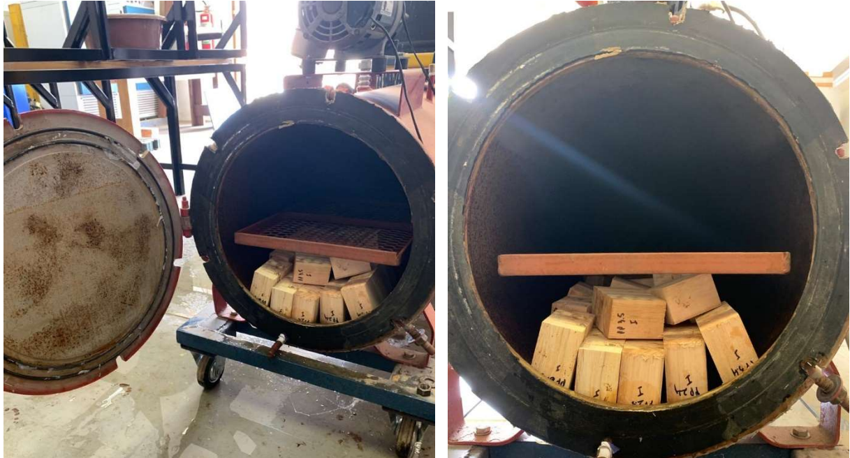
Figura 43 – Corpos de prova no interior da autoclave para ensaio de delaminação.
