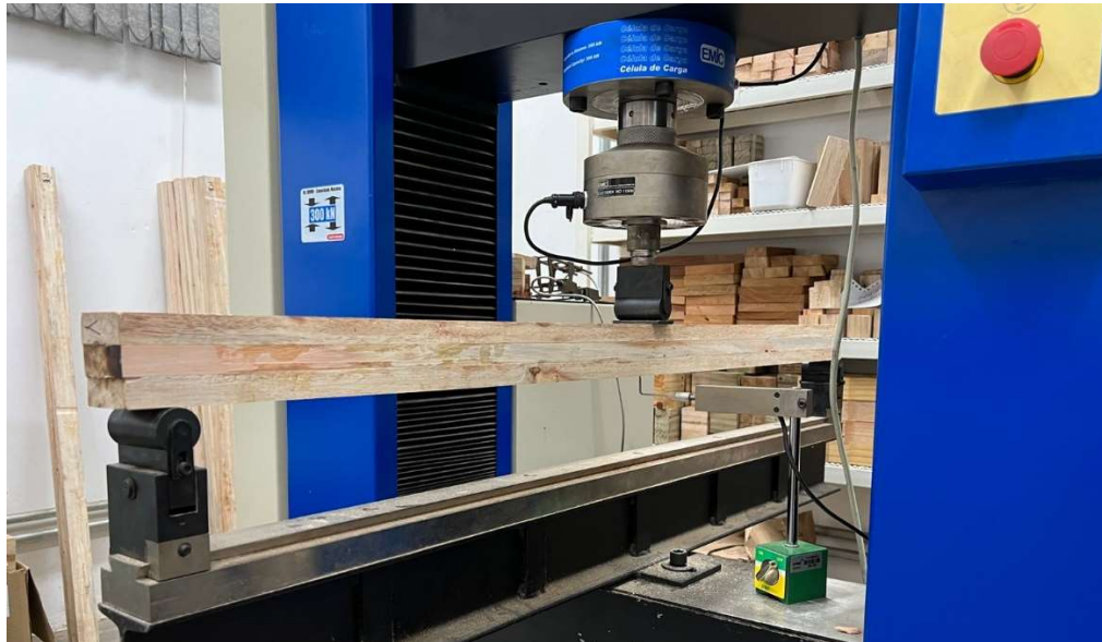
Figura 45 – Ensaio de flexão dos elementos de MLC.
