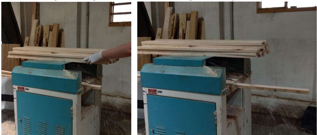
Figura 27 – Aplainamento das lamelas em plaina desengrossadeira.
