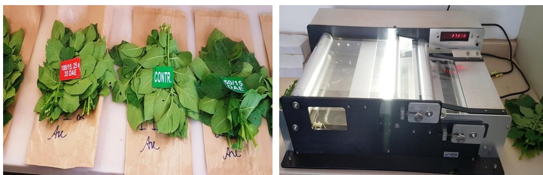
Figura 7 - Amostragem de quinze folhas por parcela experimental (A) e avaliação no integrador de área foliar de bancada (B)
