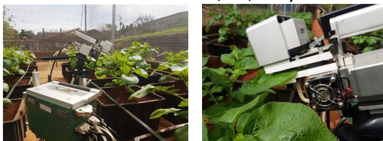
Figura 3 - Analisador de gás por infravermelho (IRGA, Li-Cor® -Li6400 XT, Lincoln, NE, USA)
