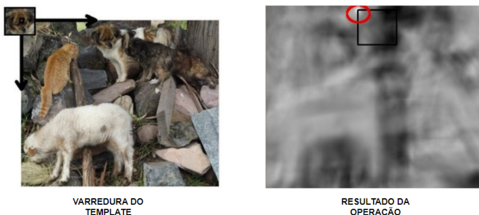
Figura 23 – Exemplo de template matching usando filtro de correlação.
