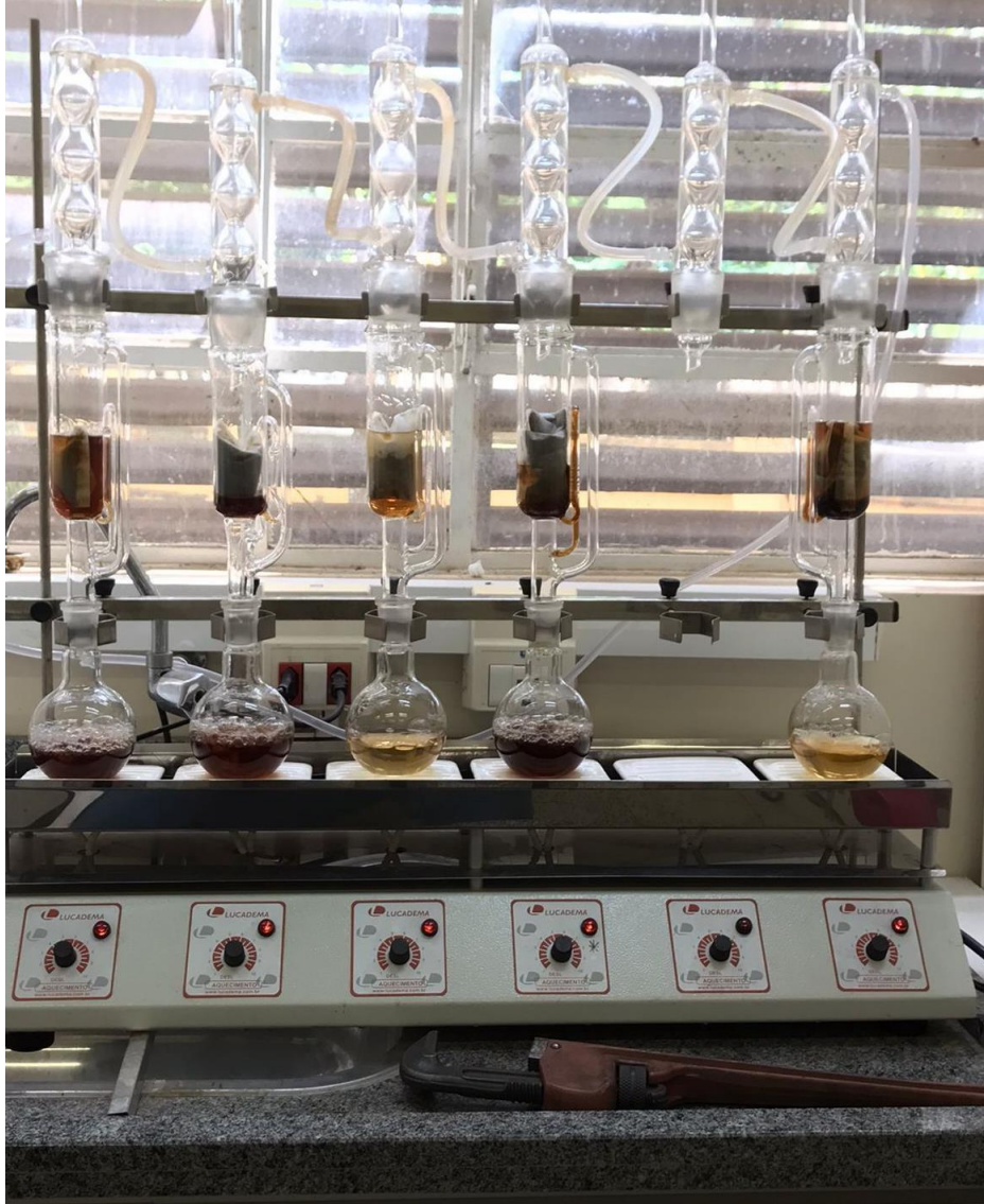
Figura 5. Remoção de extrativos em sistema Soxhlet com água destilada
