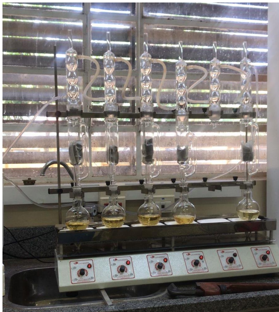
Figura 4. Remoção de extrativos em sistema Soxhlet com etanol 96%
