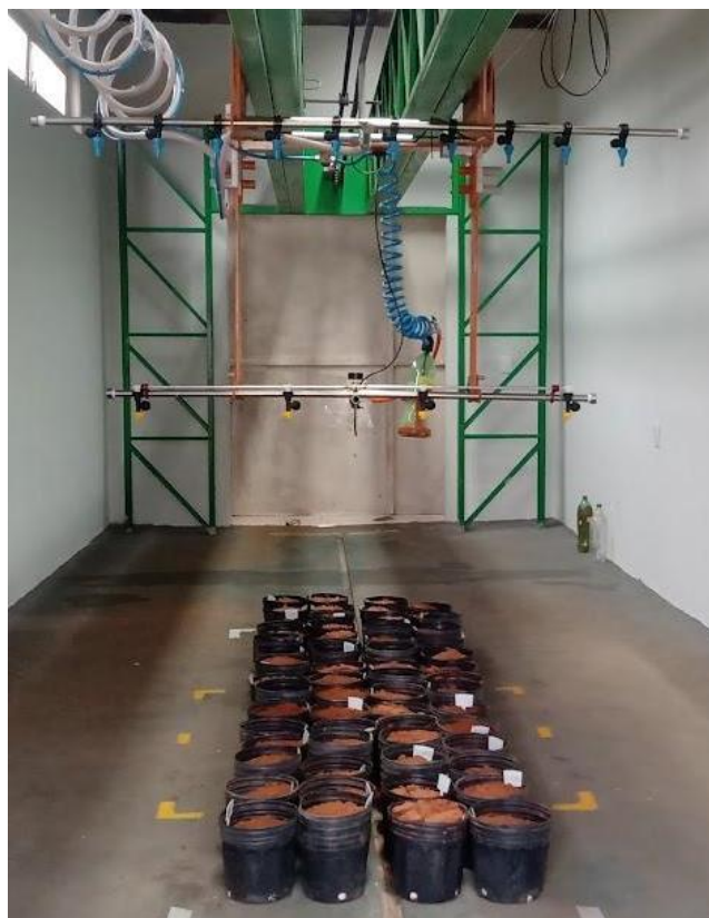
Figura 3. Aplicação do herbicida Combine® por meio de um pulverizador laboratorial. (Fonte: Própria autora).
