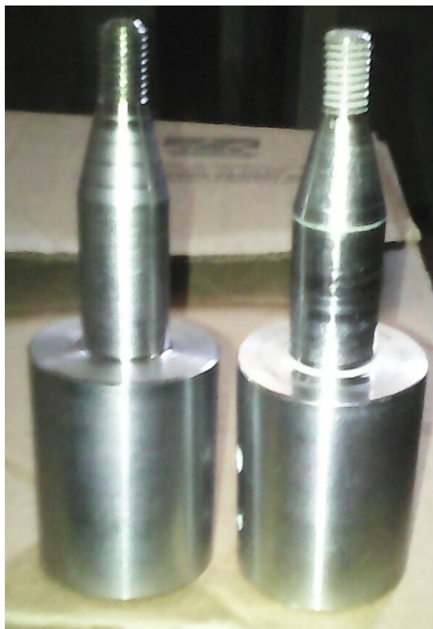
Figura 26 - Peça original e modelo reproduzido utilizando Engenharia Reversa
