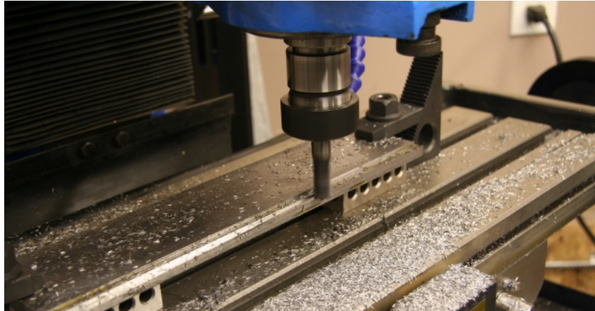
Figura 3 - Peça sendo usinada por meio de fresamento
