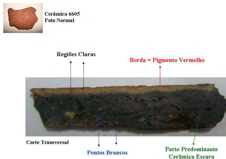
Figura 6: corte transversal da cerâmica 6605.
