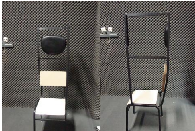
Figura 17 – Cadeira Modificada e Instrumentada com escalas graduadas para realização do experimento
