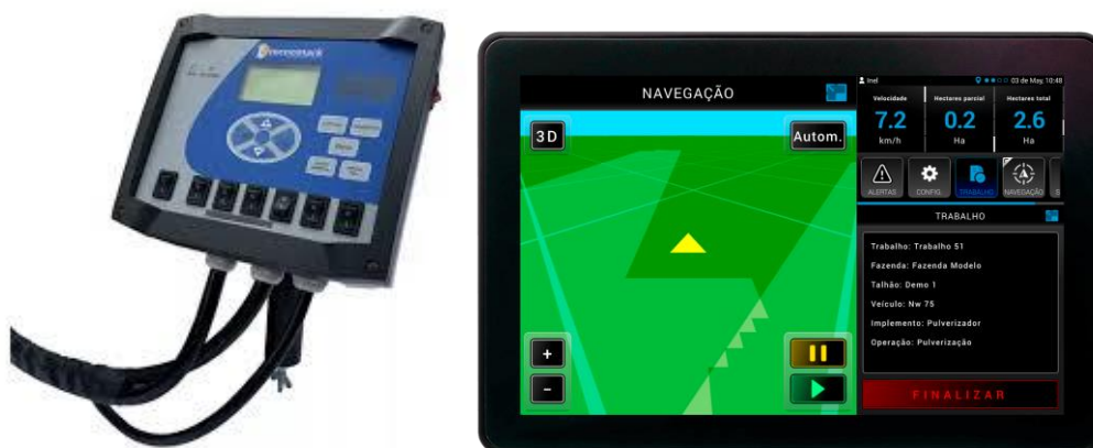
Figura 1 - Painel controlador [12] (à direita) e monitor de um controlador de pulverização com GPS agrícola [13] (à esquerda).
