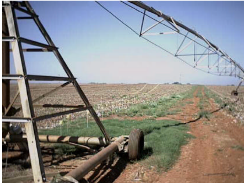
Figura 3. Vista do equipamento e coletores durante o ensaio de precipitação.
