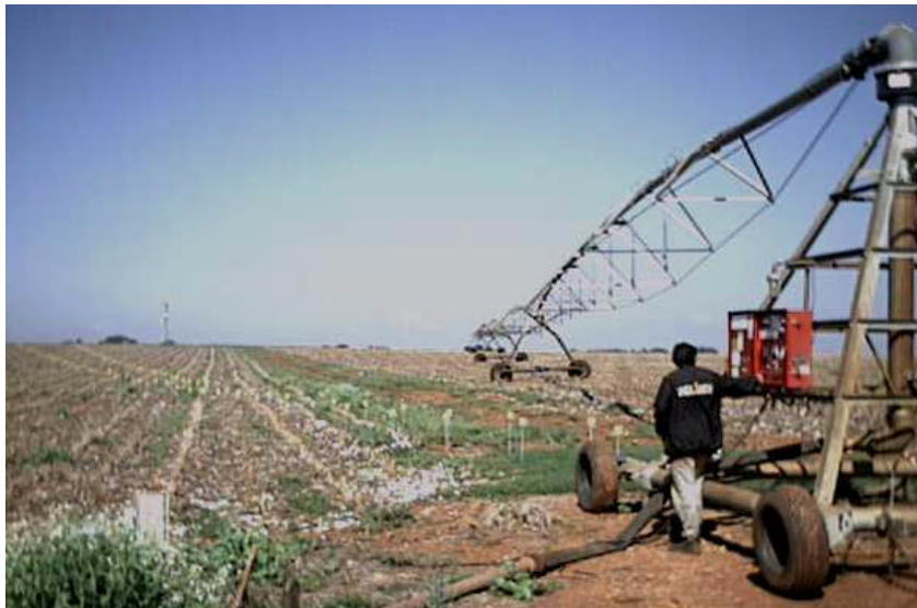
Figura 2. Vista do equipamento e coletores durante o ensaio de precipitação.
