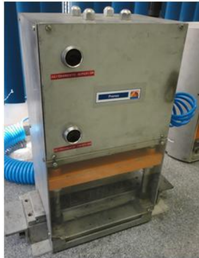
Figura 27 - Prensa de estampagem dos corpos de prova.
