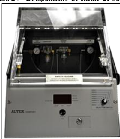
Figura 24 - Equipamento de ensaio de buckle .
