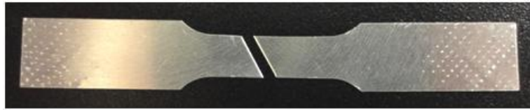
Figura 30 - Corpo de prova após ensaio de tração.
