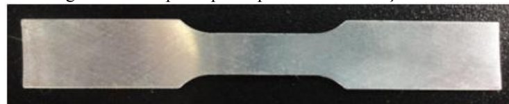
Figura 28 - Corpo de prova para ensaio de tração.
