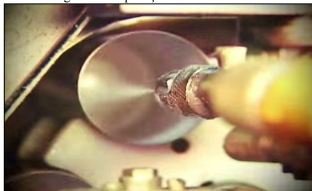
Figura 20 - Aplicação do verniz interno.
