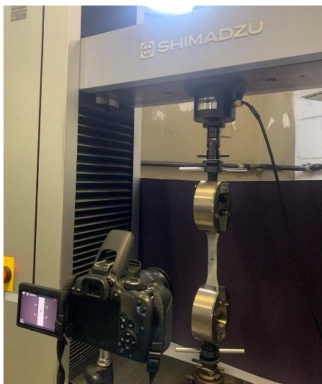
Figura 5– Máquina SHIMADZU no laboratório de ensaios preparado para o ensaio de tração.
