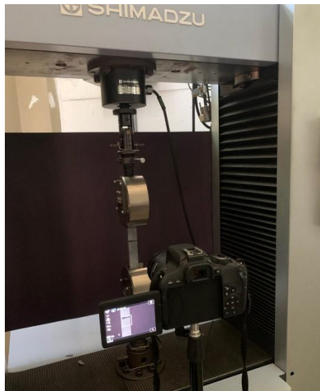
Figura 11 – Máquina SHIMADZU no laboratório de ensaios preparado para o ensaio de tração.
