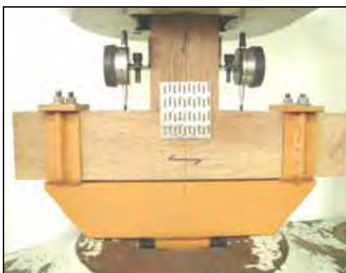
Figura 29 – Ensaio de arrancamento normal às fibras
