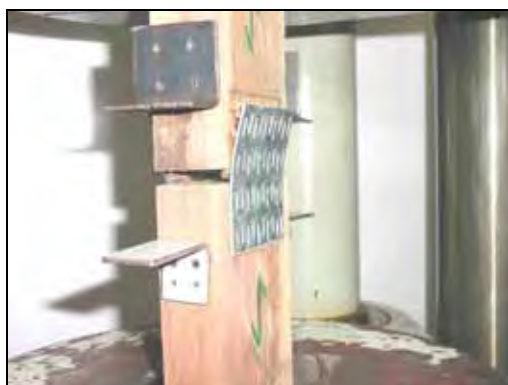
Figura 28 – Ruptura característica para o ensaio de arrancamento paralelo às fibras
