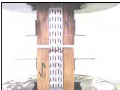
Figura 34 – Ruptura característica para o ensaio de tração da chapa
