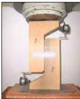
Figura 31 – Ensaio de cisalhamento da chapa
