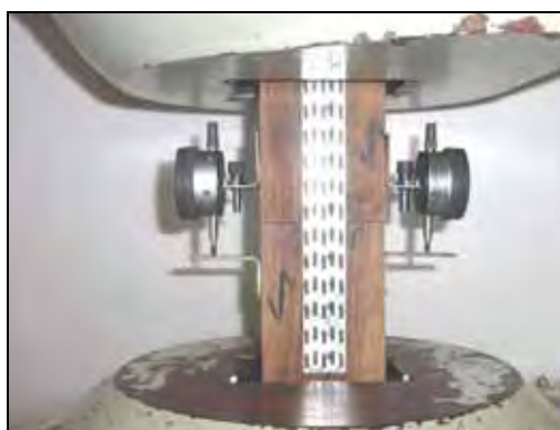
Figura 33 – Ensaio de tração da chapa
