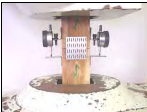
Figura 27 – Ensaio de arrancamento paralelo às fibras
