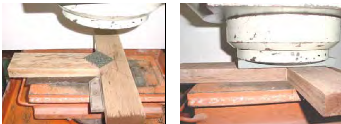
Figura 22 – Prensagem da CDE no modelo de arrancamento normal às fibras
