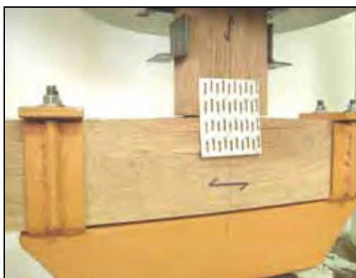
Figura 30 – Ruptura característica para o ensaio de arrancamento normal às fibras
