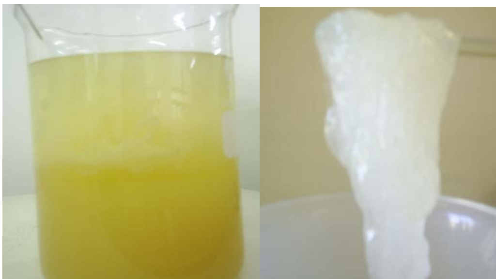
Figura 22: Caldo de fermentação e goma sendo extraída com a adição de álcool.
