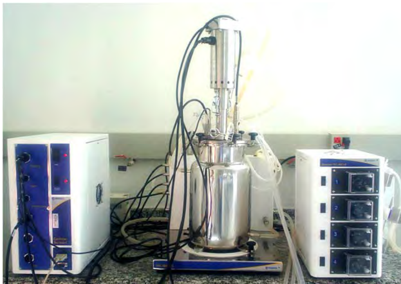
Figura 8: Fermentador de 7 litros utilizado para produção de xantana por Xanthomonas campestris pv. campestris .
