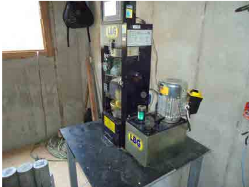
Figura 8 - Prensa hidráulica instalada na obra Fonte: Autor
