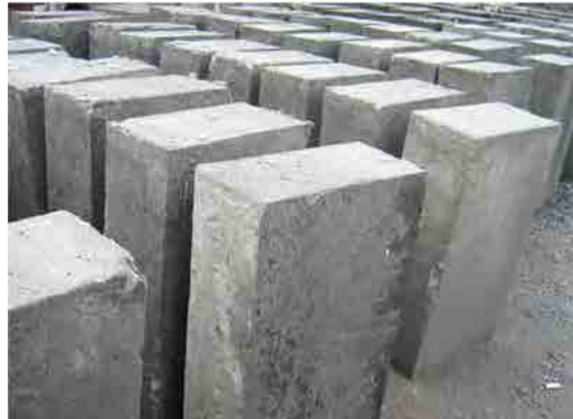
Figura 39 - Bloco maciço de concreto
