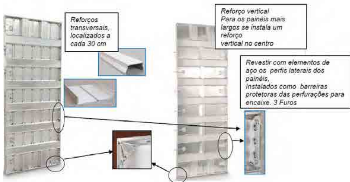
Figura 10 - Painéis de forma de alumínio Fonte: Autor
