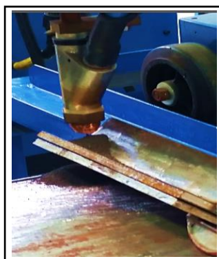
Figura 19 - Testes preliminares dos parâmetros de soldagem.
