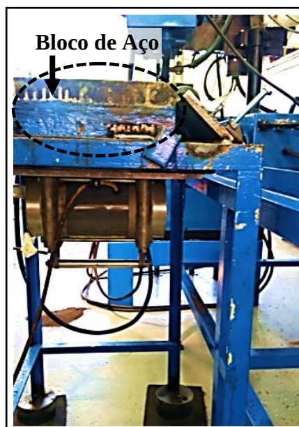
Figura 18 – Bloco de aço, pontado sobre a mesa para aumentar massa do conjunto.
