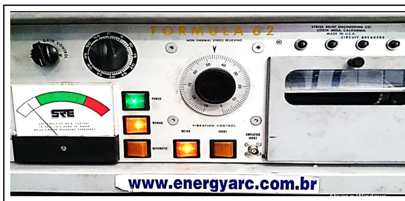
Figura 21 - Painel de controle do equipamento de vibrações.
