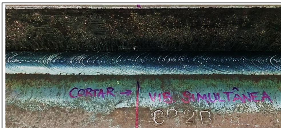
Figura 103 - Cordão de solda - CP2: Soldagem com vibração simultânea
