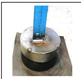
Figura 13 - Pés da mesa com os isoladores de borracha.
