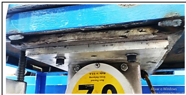
Figura 16 - Fixação do indutor de vibrações.
