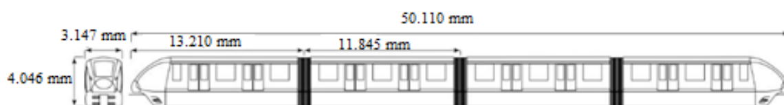
Figura 11 – Dimensões do modelo INNOVIA 300 da empresa Bombardier
