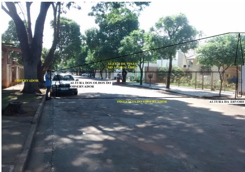
Figura 59: Modo de uso do astrolábio: visão do observador em relação à árvore
