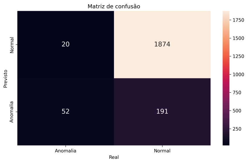
Figura 34 – Matriz de confusão para o modelo de deep autoencoder esparso com threshold = 4,9
