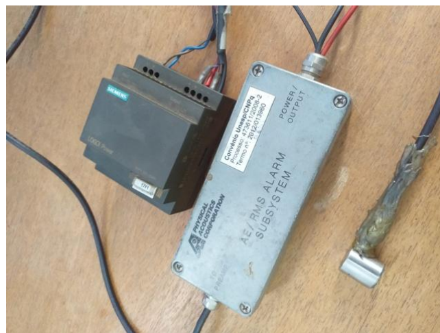
Figura 13 – Módulo emissão acústica (1), sensor (2) e amplificador (3).
