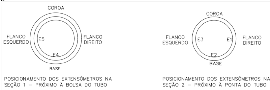
Figura 38 - Posicionamento dos extensômetros no tubo com diâmetro de 600 mm - PA1
