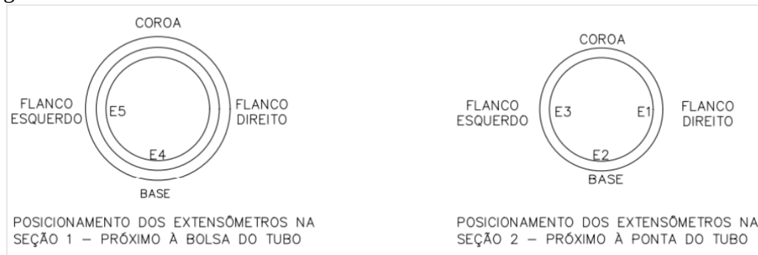
Figura 21 - Posicionamento dos extensômetros no tubo com diâmetro de 400 mm - PA1
