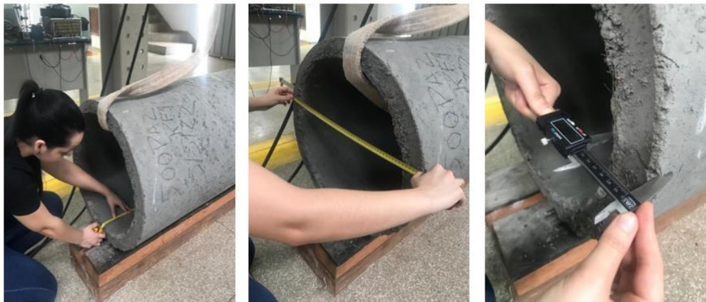
Figura 8 – Aferição das dimensões do tubo
