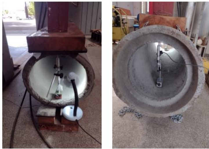
Figura 16 - Posicionamento dos LVDTs na região da ponta e bolsa do tubo
