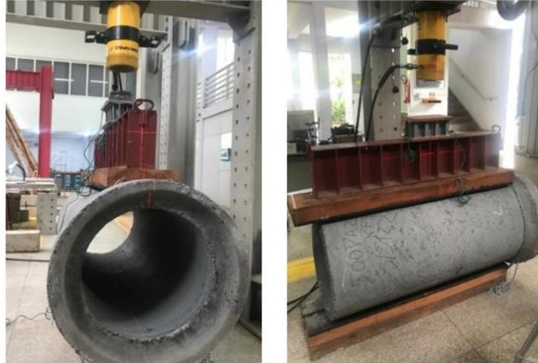
Figura 9 - Alinhamento dos perfis metálicos e dispositivos utilizados para a aplicação da força em relação ao eixo da bolsa do tubo
