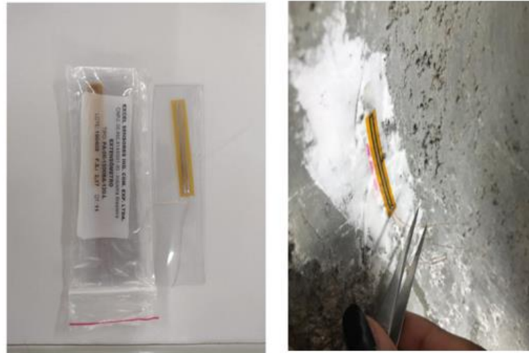
Figura 12 - Especificação do extensômetro e seu posicionamento no tubo
