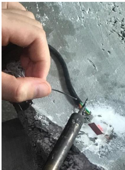
Figura 15 - Soldagem dos fios do extensômetro ao cabo do sistema de aquisição
