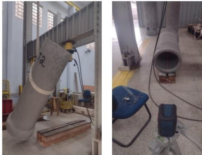
Figura 7 - Posicionamento do tubo sobre o sarrafo de madeira e alinhamento do eixo do tubo com o eixo do sarrafo de madeira através do nível à laser
