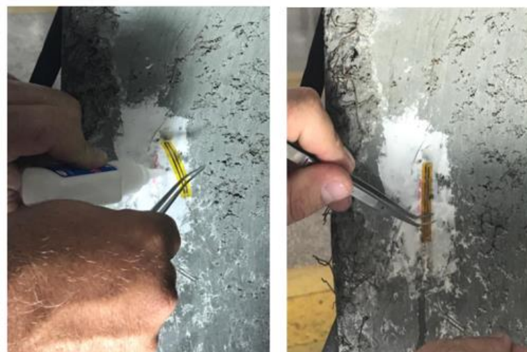
Figura 13 - Aplicação da cola e posicionamento final
